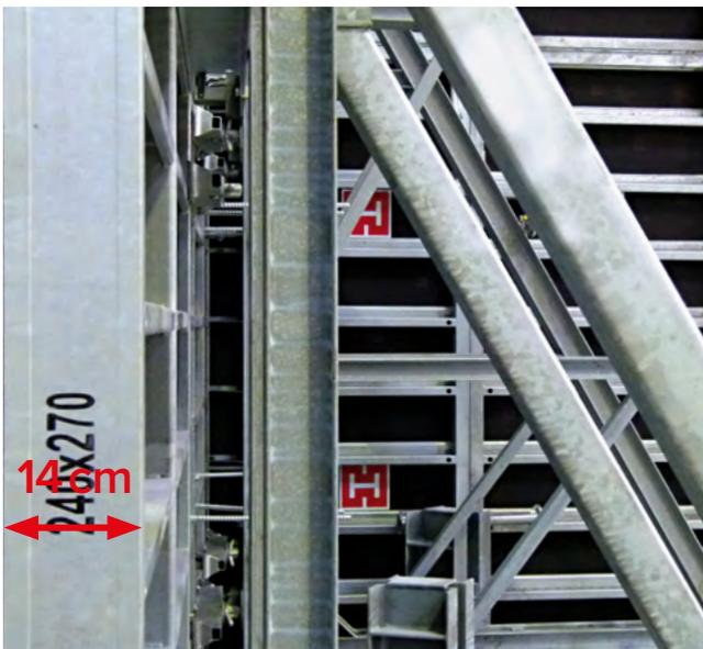
► Hohe Biegesteifigkeit aufgrund des 14 cm hohen Stahlrahmens; zulässiger Betondruck 80 kN/m<sup>2</sup>
